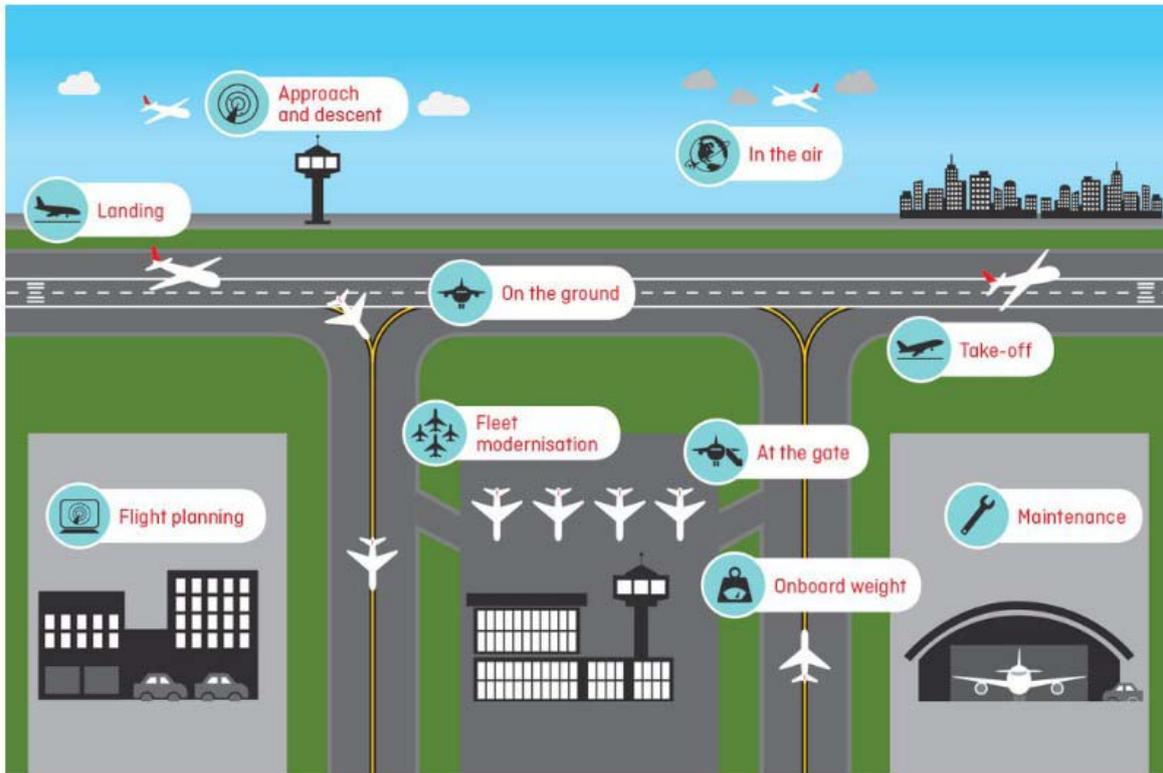
Entre las principales iniciativas destacan la modernización de la flota, implementación de procedimientos RNP de aproximación y descenso, mejoras en la planificación de vuelos, configuración reducida de flaps durante el aterrizaje, reversores en idle, taxeo con un solo motor, utilización de equipos auxiliares en tierra, política de lavado de motores, entre otros.
